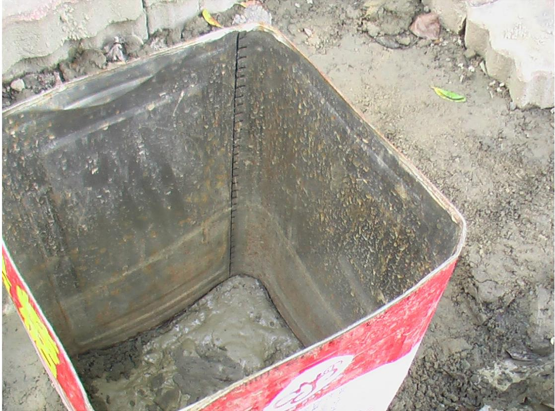
圖一、測量用之沙拉油空桶及刻度
