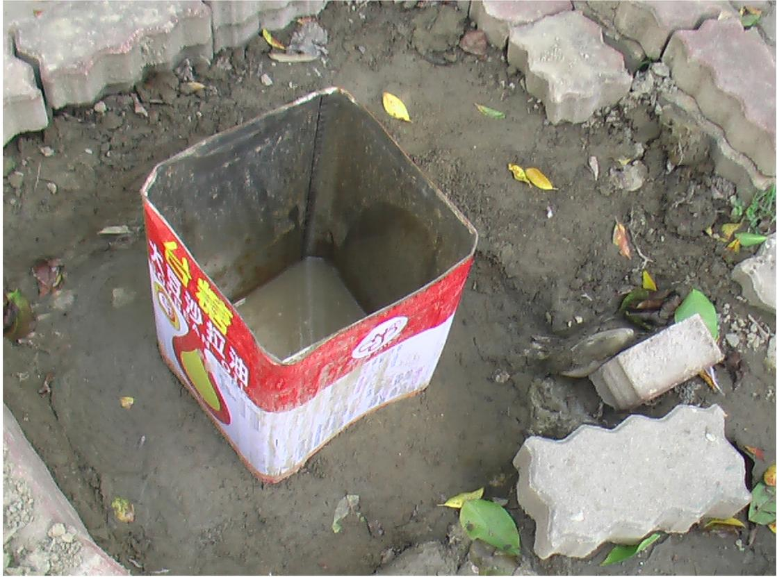
圖四、連鎖磚下級配層之透水力測量情形
