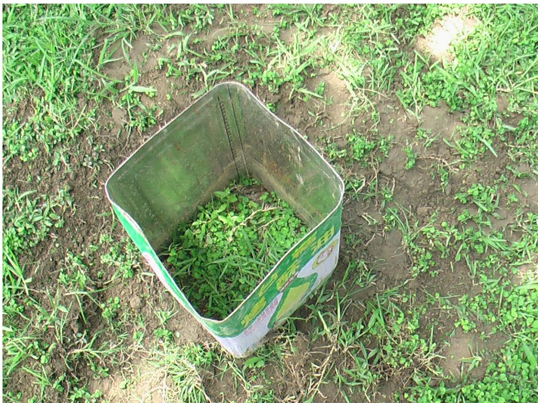
圖二、草地上透水力測量情形
