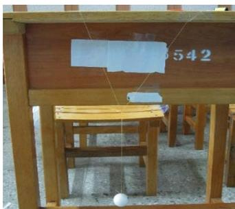
圖一、實驗敲擊裝置圖。
