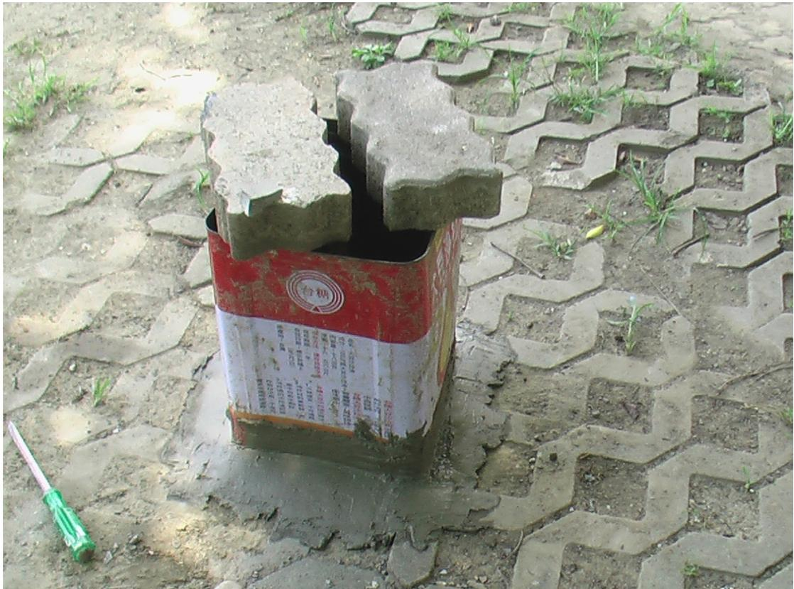
圖六、連鎖磚及植草磚上之透水力測量情形
