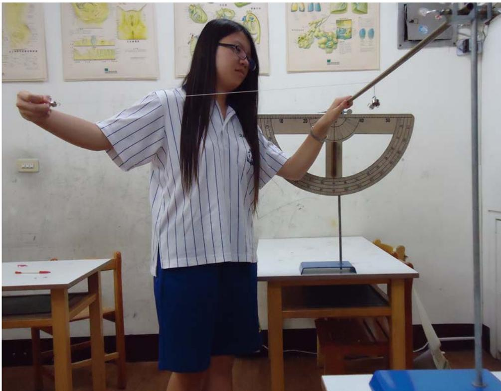
圖六、實驗設備：棉繩、法碼、銅棍、鐵架
